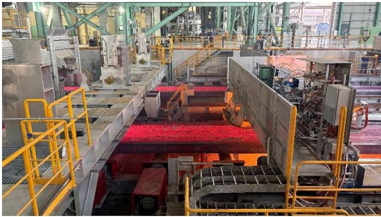
A máquina de lingotamento contínuo incluiu uma inovadora solução de software da Primetals Technologies, que determina, ainda na fase de projeto, a geometria de rolo ideal para prevenir oscilações do nível do molde.
