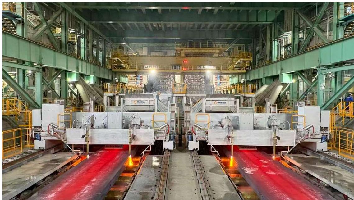
Nova máquina de lingotamento contínuo de placas ultragrossas da Baosteel (fornecida pela Primetals Technologies) pode produzir placas com espessura de até 460 mm.
