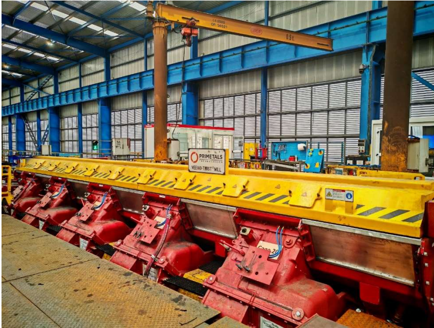
普锐特冶金技术为 Celsa 法国公司的线材轧机新安装的摩根 Vee No-Twist 轧机
