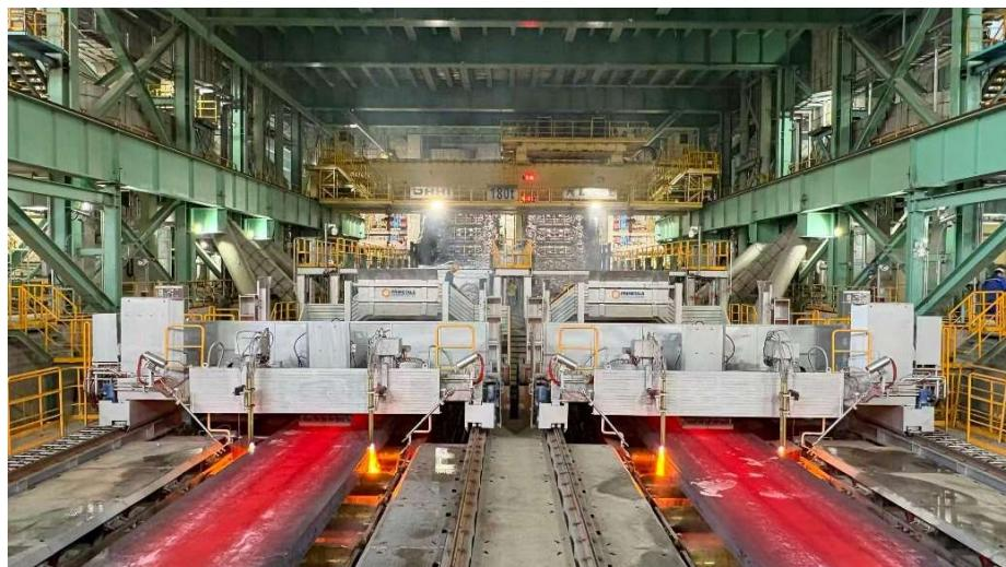
宝鋼に新設された極厚スラブ No. 5 連続鋳造機は最大板厚 460 ミリメートルのスラブを生産
