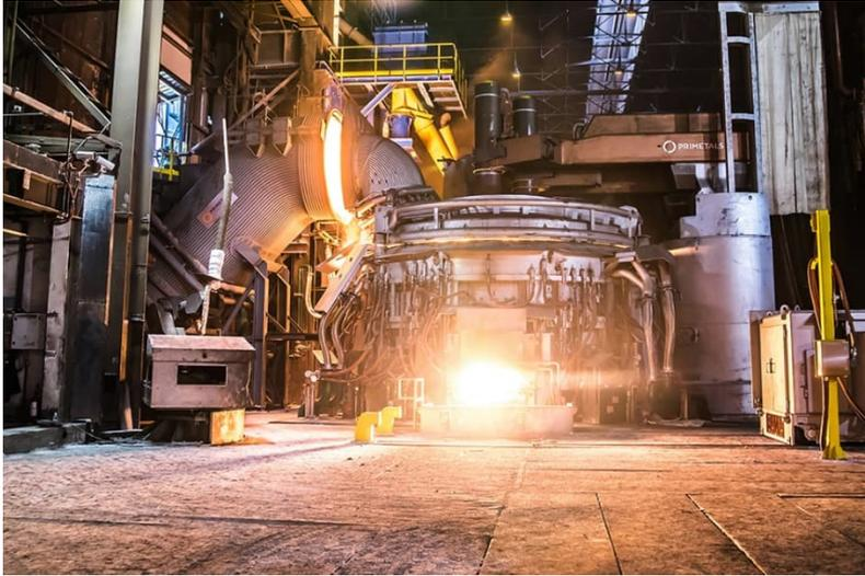
Planta de forno elétrico a arco EAF Ultimate da Primetals Technologies.
