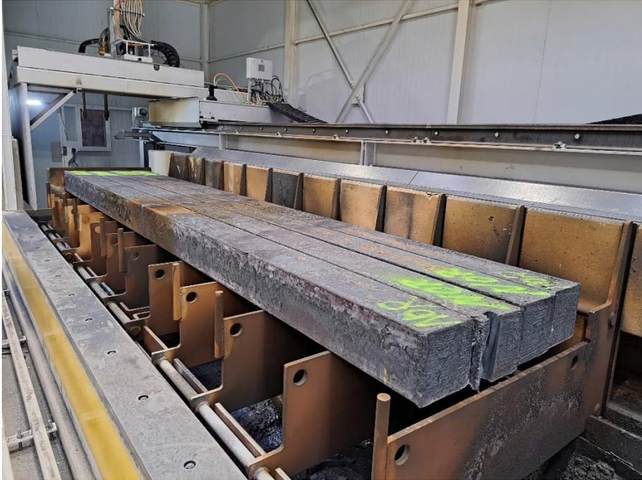
Die Schrott-Brennschneidmaschine von Primetals Technologies verarbeitet verschiedene Arten von Schrott, darunter Knüppel, Walzstahlbündel, Pfannen- und Verteilerbären.
