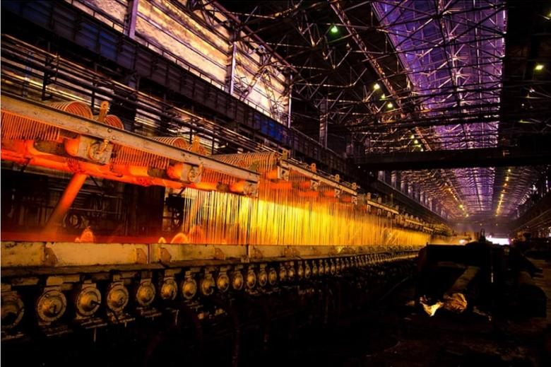
Секция охлаждения на стане горячей прокатки полосы SAIL Vokaro. Модернизация Primetals Technologies распространялась на оборудование средств автоматизации для чистой группы клетей, секции охлаждения, моталки и конвейера рулонов.
