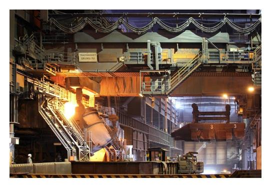
Загрузка конвертера на заводе Salzgitter Flachstahl. Компания Primetals Technologies недавно внедрила модуль Slag Expert на двух кислородных LD-конвертерах (КК) в г. Зальцгиттер, Германия.
