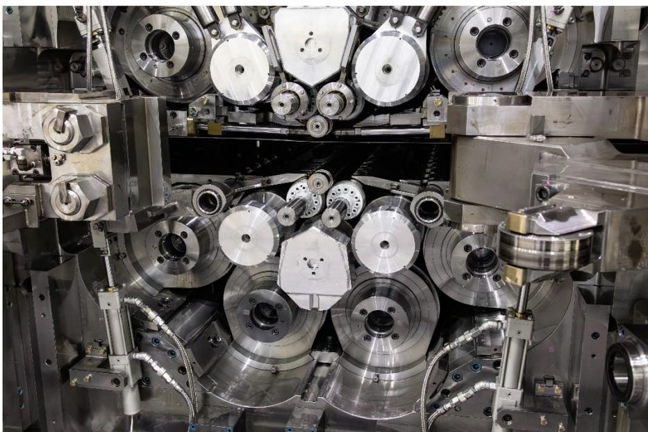
Das neue Reversier-Kaltwalzwerk produziert Kaltband mit Dicken von bis zu 0,2 Millimetern bei Walzgeschwindigkeiten von bis zu 1.000 Metern pro Minute.
