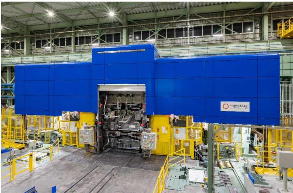
Das neue HZ-Walzgerüst von Nippon Yakin Kogyo mit geteiltem Gehäuse ersetzt zwei Monoblock-Kaltwalzwerke.
