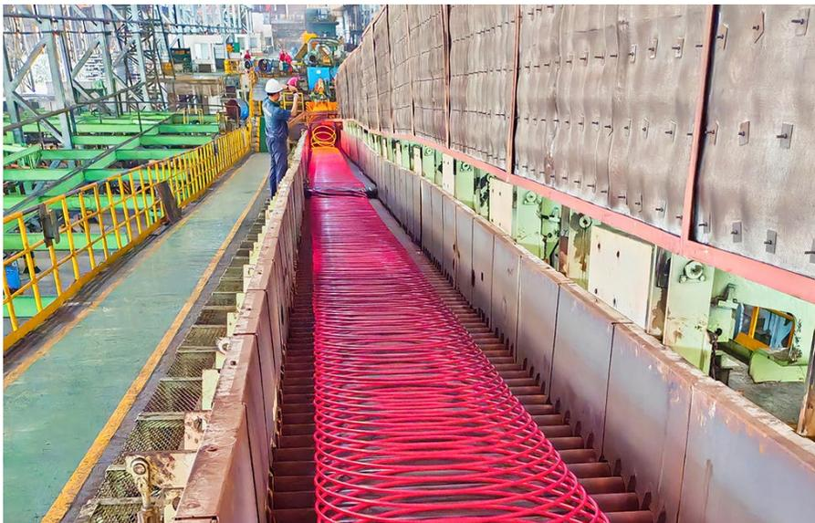
Горячекатаный бунт на охлаждающем конвейере Morgan Stelmor от Primetals Technologies на линии №3 Jiangsu Shagang.
