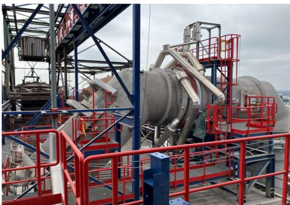
Teil des Abwärmerückgewinnungssystems von Primetals Technologies bei Aperam Genk.
