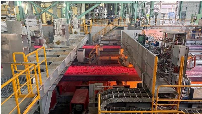
Машина непрерывного литья оснащена прорывным программным решением компании Primetals Technologies, которое уже на этапе проектирования определяет оптимальную геометрию роликов для предотвращения колебаний уровня металла в кристаллизаторе.
