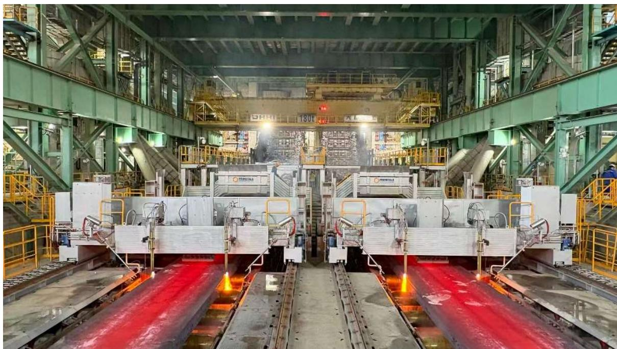
Новая машина непрерывного литья сверхтолстых слябов компании Baosteel, поставленная Primetals Technologies, позволяет производить слябы толщиной до 460 мм.
