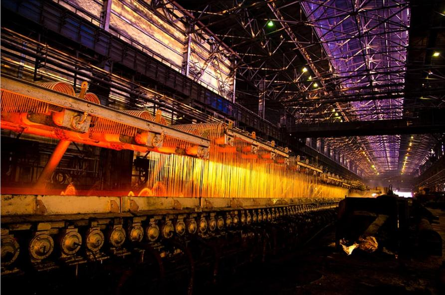
Kühlstrecke in der Warmbandstraße von SAIL Bokaro. Die Modernisierung durch Primetals Technologies umfasste die Automatisierungsausrüstung für die Fertigstraße, die Kühlstrecke, den Unterflurhaspel und das Bund-Transport-System.
