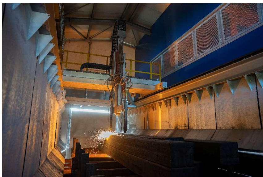
废料切割机可以切割各种废料，包括规格不一的钢坯、钢轨、轧辊和成捆的轧制棒材。
