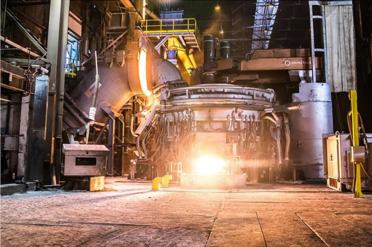
普锐特冶金技术超高功率电弧炉 (EAF Ultimate) 设备。
