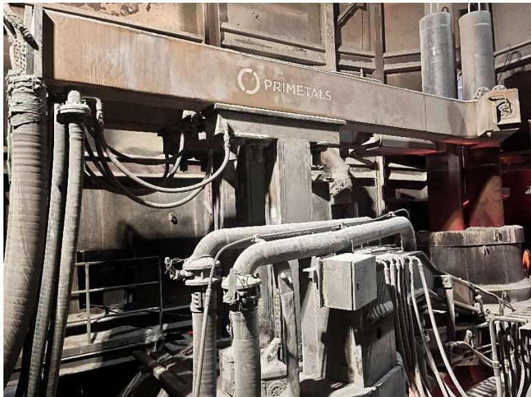
普锐特冶金技术为通化钢铁提供的新电极横臂将显著提升功率输出并降低能耗。
