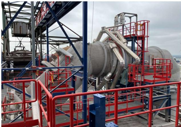
Vista parcial do sistema de recuperação de calor perdido da Primetals Technologies na Aperam Genk.
