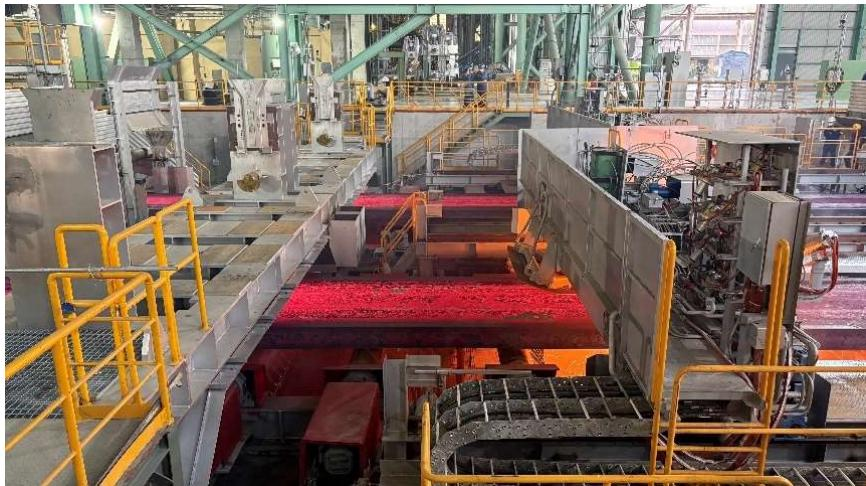
该连铸机配备了普锐特冶金技术的突破性软件解决方案，可在设计初期就确定理想辊列布置，从而有效避免结晶器液位波动。
