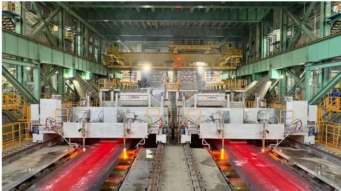
普锐特冶金技术为宝钢提供的新建超厚板坯连铸机可生产厚度达 460 毫米的板坯。
