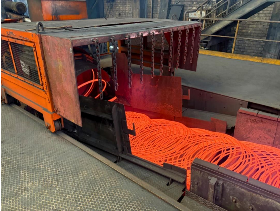
レイニングヘッドから冷却コンベヤに出てくる直径 8 ミリの線材近影
