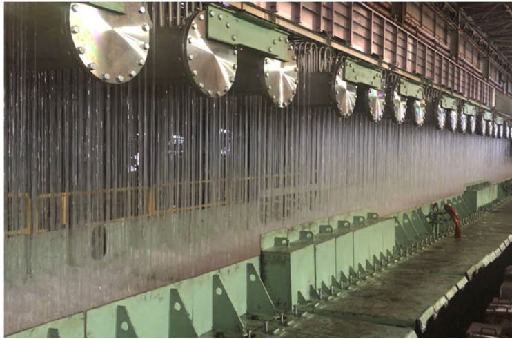
Laminarkühlstrecke in der Warmwalzanlage der voestalpine Stahl GmbH.
