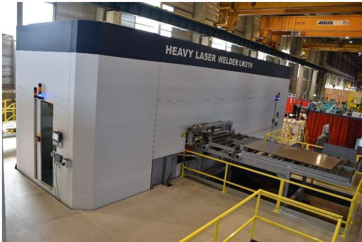
酸洗线现代化改造将安装先进的激光焊机(LBW)。图中所示与东洋钢板将要安装的焊机型号相同。
