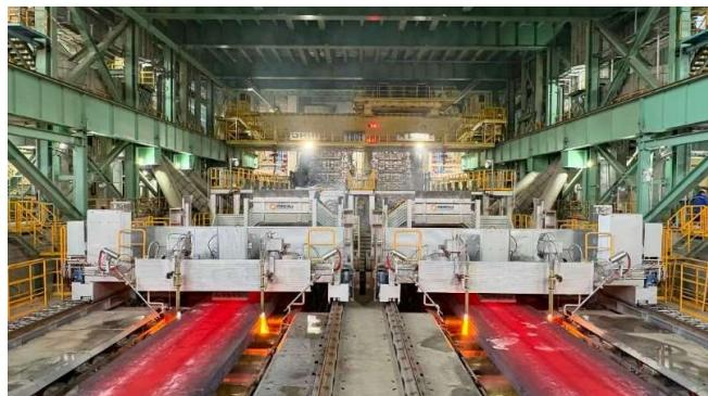
Die neue Ultra-Dickbrammen-Stranggießanlage von Primetals Technologies für Baosteel kann Brammen mit einer Dicke von bis zu 460 Millimetern herstellen.
