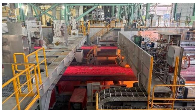
Die Gießanlage verfügt über eine bahnbrechende Softwarelösung von Primetals Technologies, die bereits in der Konstruktionsphase die ideale Rollengeometrie ermittelt, um Schwankungen des Niveaus der Kokille zu verhindern.
