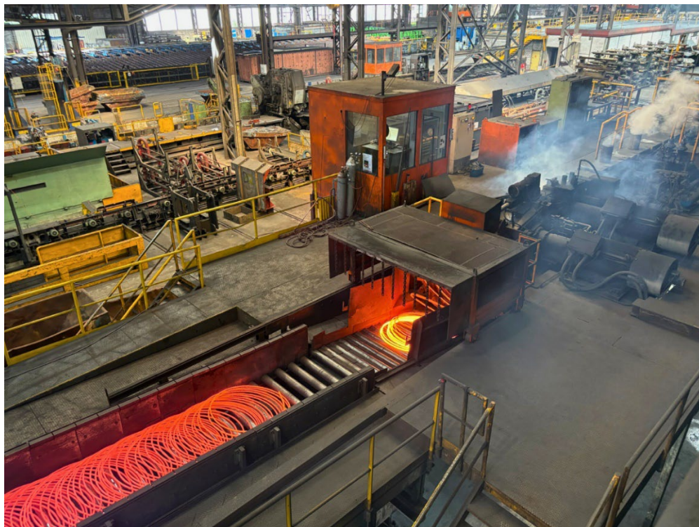
8-миллиметровый пруток выходит из виткообразователя на охлаждающий конвейер на новом прутковом стане Stahl Gerlafingen от Primetals Technologies.
