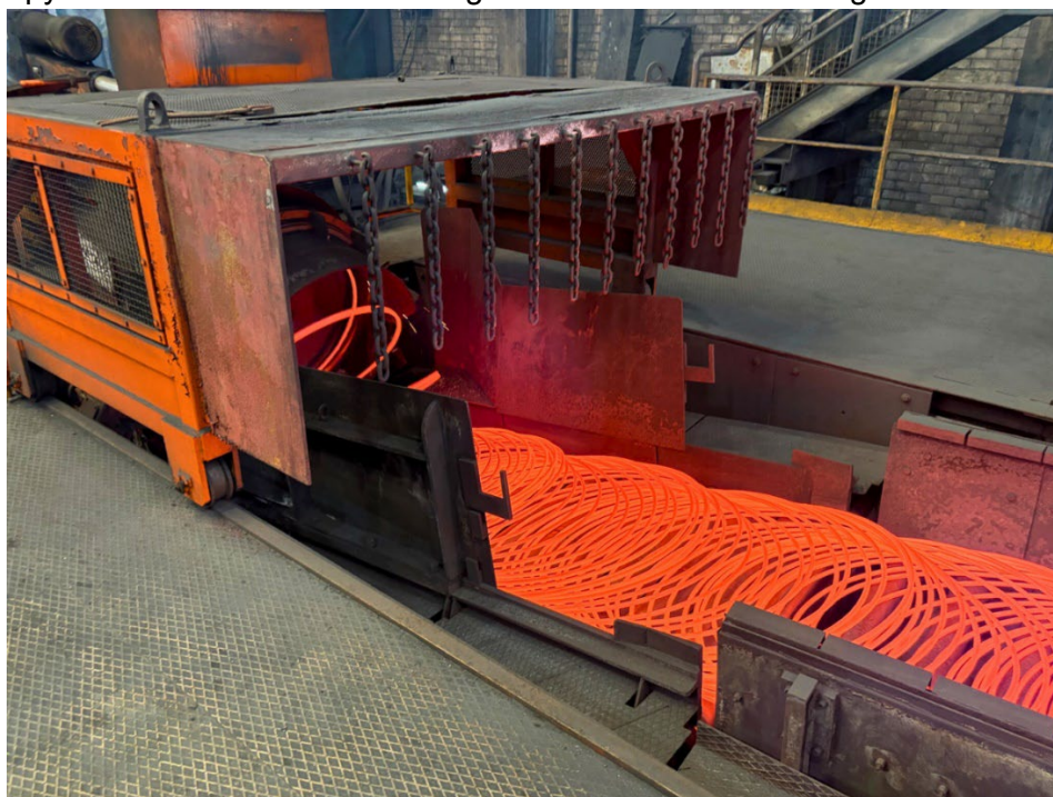
Крупный план: 8-миллиметровый пруток выходит из виткообразователя на охлаждающий конвейер на новом прутковом стане Stahl Gerlafingen от Primetals Technologies.
