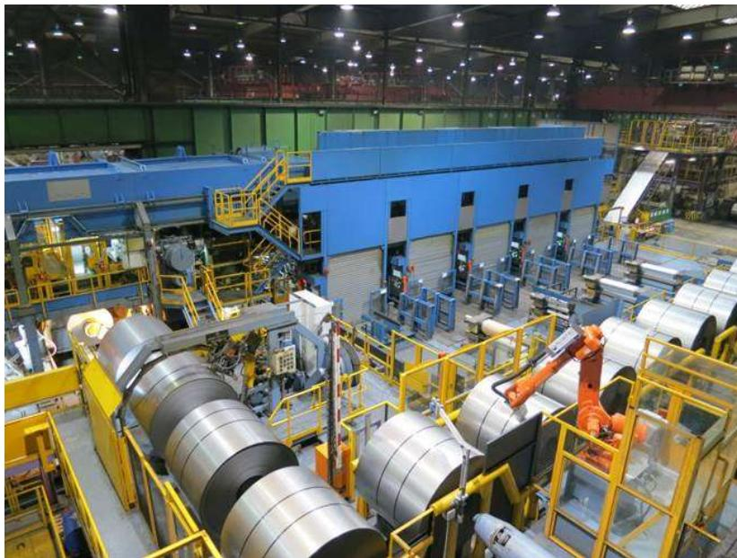
普锐特冶金技术将为奥钢联钢铁公司升级 BETA 2 酸洗冷轧联合机组(PLTCM)。
