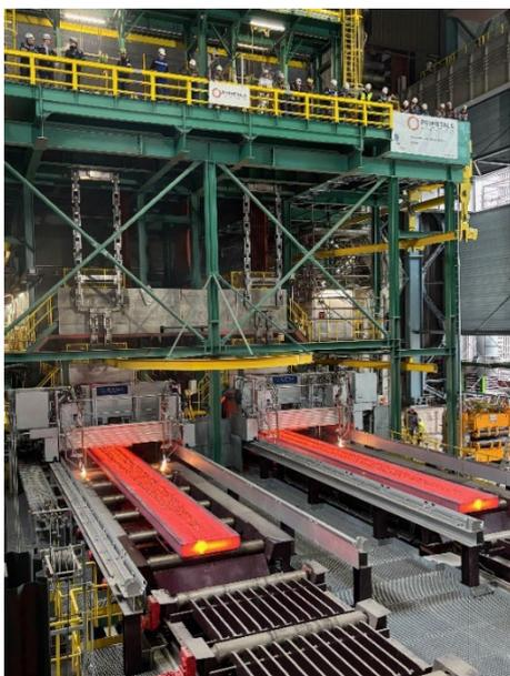
Die neue Stranggießanlage Nr. 4 von thyssenkrupp Steel, geliefert von Primetals Technologies, verfügt über fortschrittliche mechanische Komponenten und Automatisierungslösungen.
