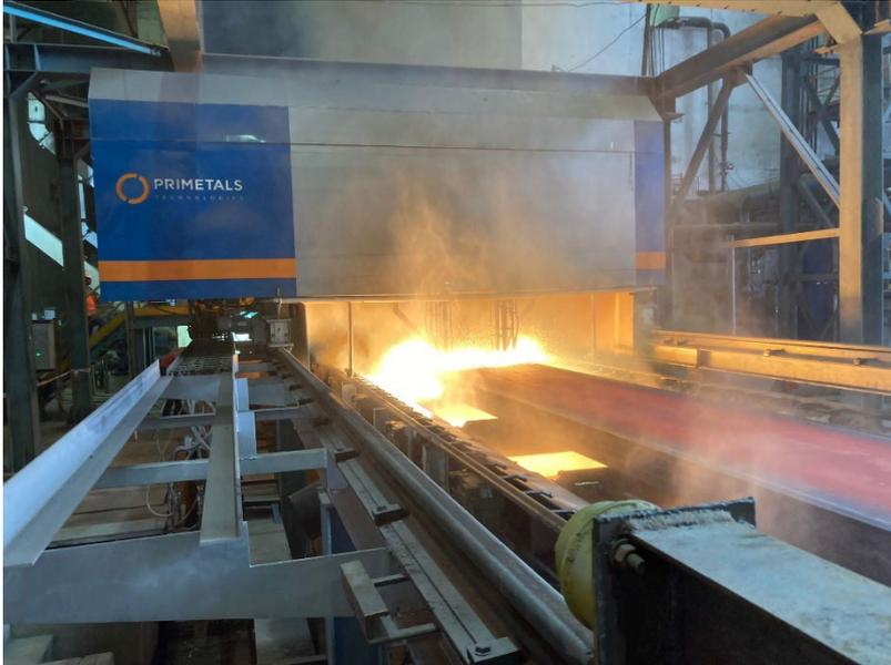
Solução de corte a maçarico da Primetals Technologies implementada na planta da JSL em Jajpur.
