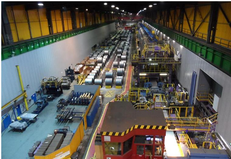
プライメタルズ テクノロジーズが更新するフェストアルピーネの BETA 2 酸洗ラインおよびタンデム冷間圧延機 (PLTCM)
