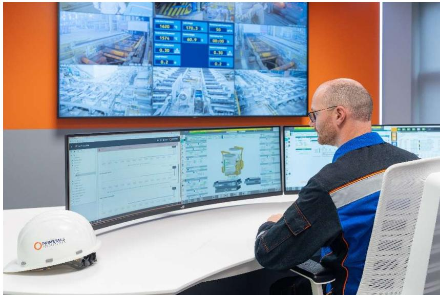
Das Central Operation Cockpit (COC) ist ein hochinnovativer zentraler Leitstand, mit dem ein einzelner Bediener mehrere Anlagenbereiche steuern kann.
