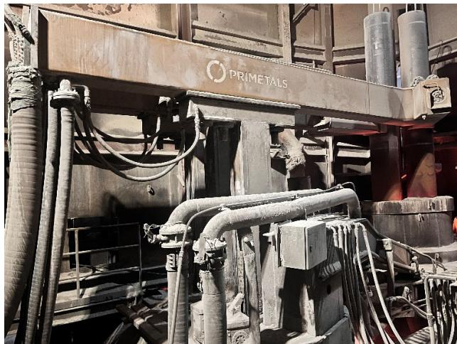
Neue Elektrodenarme von Primetals Technologies steigern die Stromleistung und senken den Energieverbrauch bei Tonghua Iron and Steel.
