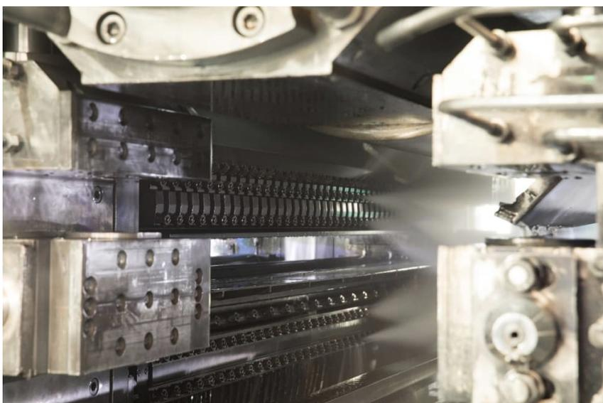
一套铝箔轧机上安装的普锐特冶金技术的 ISV 喷淋系统。
