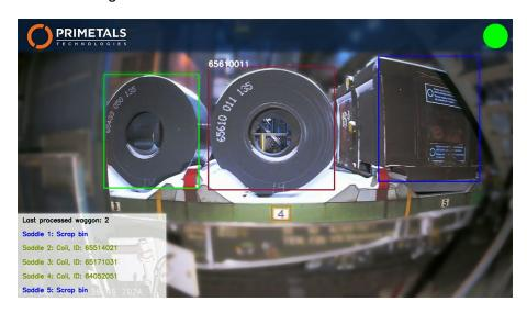
Bund-ID-Erkennung bei SSAB Hämeenlinna durch das KI-gestützte Assistenzsystem von Primetals Technologies.
