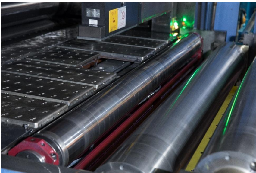
Dingsheng の圧延機の 1 基に設置されたプライメタルズ テクノロジーズ製 Air Bearing ShapeMeter
