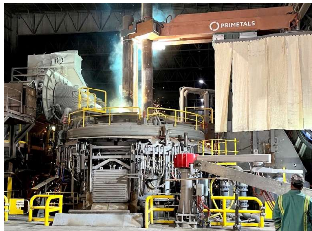
プライメタルズ テクノロジーズが更新した NLMK インディアナ 118 トン EAF の初湯の様子
