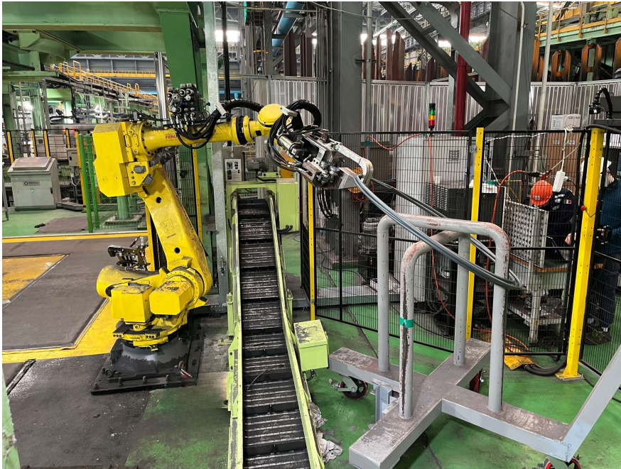
Robô autônomo TrimRob da Primetals Technologies Polytec para amostragem e aparação de bobinas.
