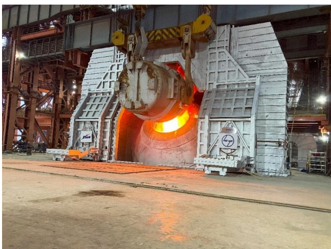
プライメタルズ テクノロジーズが供給した JVML の LD 転炉（BOF）「H」における初回装入
