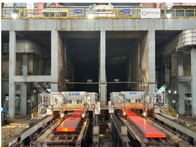
トラナガルにある JVML の 2 ストランド連続スラブ casting 機 2 基
