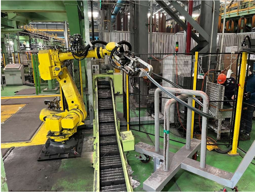
普锐特冶金技术与 Polytec 联合开发的 TrimRob 自主式盘卷修剪与取样机器人
