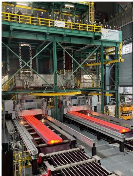
高度な機械設備を備えた 2 スtrand スラブ連続鋳造機 No. 4
