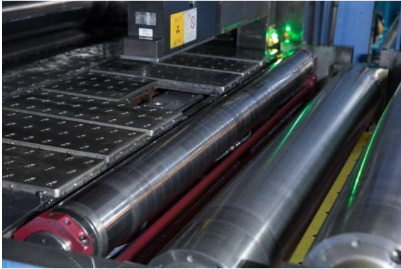
江苏鼎胜新材料轧机上安装的普锐特冶金技术空气轴承板形仪。
