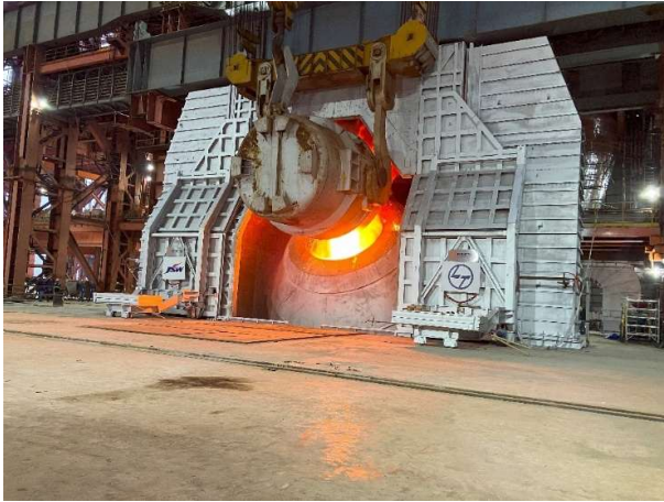
Die erste Beschickung des von Primetals Technologies gelieferten LD-Konverters (BOF) „H“ von JVML.
