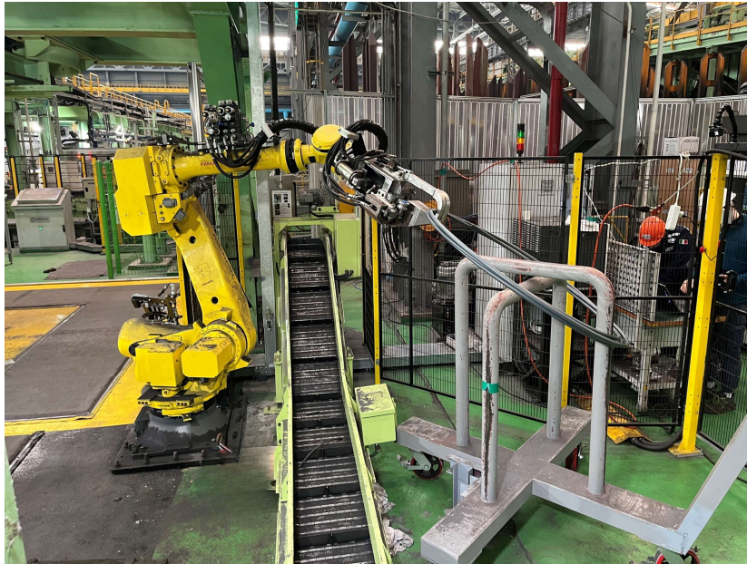
TrimRob – autonomer Roboter von Primetals Technologies und Polytec zum Besäumen und Probenentnehmen der Coils
